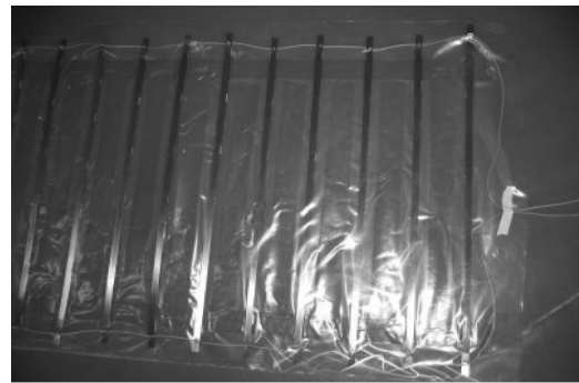
■ Figura 6. Plataforma de contactos hecha en casa
